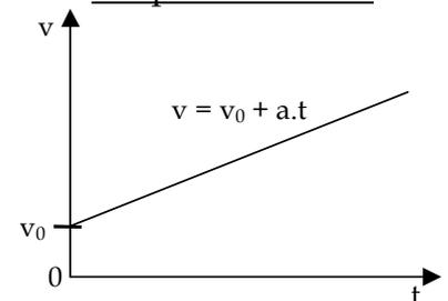
$$\text{Formule PRATIQUE : } (V_{\text{finale}}^2 - V_{\text{initiale}}^2) = 2a (X_{\text{finale}} - X_{\text{initiale}})$$
